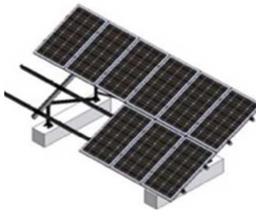
Système de longrines (plots béton)
